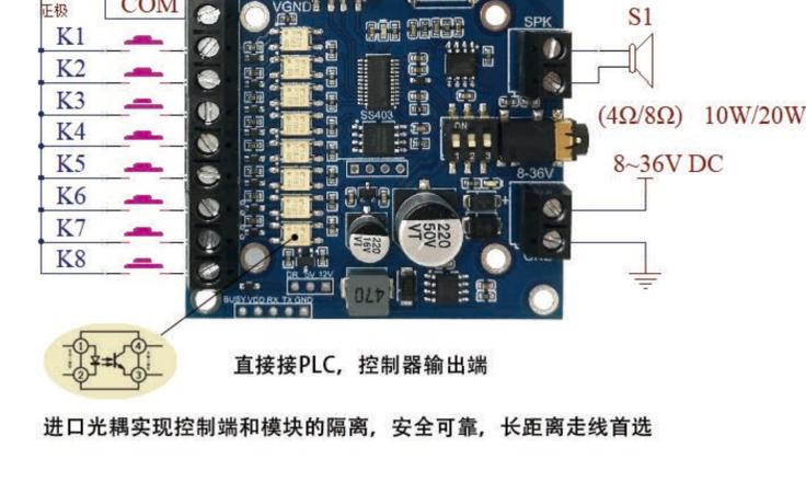
进口光耦实现控制端和模块的隔离, 安全可靠, 长距离走线首选
